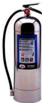
Extintor portátil de agua a presión para incendios clase A (Tamaño disponible 9.5 lts.), tienen un alcance de 16.50 mts.
