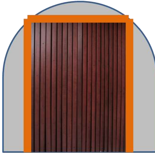
Cortina para control de ventilación
